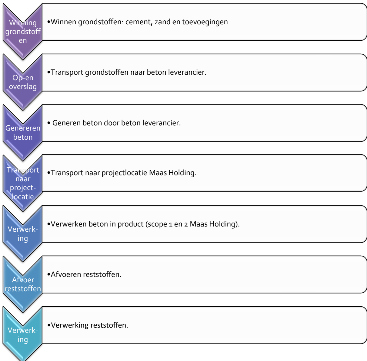
Figuur 4: beschrijving van de keten van beton
